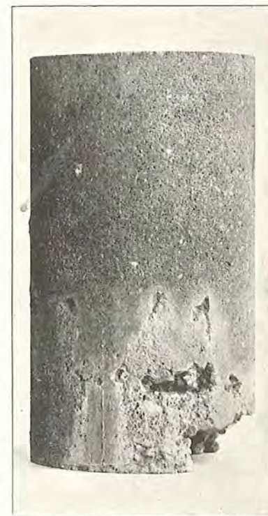
Fig. 13 a. Luftlagret Portlandcimentrør af Mørtel 1 : 2 efter Prøvningen. Rør Nr. 180.
